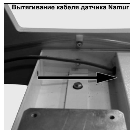
Вытягивание кабеля датчика Namur
